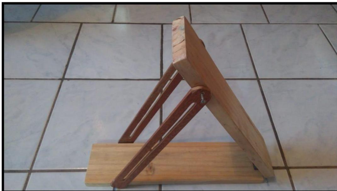
3° Passo: colocar as duas porcas borboleta na fenda de 0,5 cm para poder dar movimento e modificar os ângulos de movimentação do plano inclinado.
