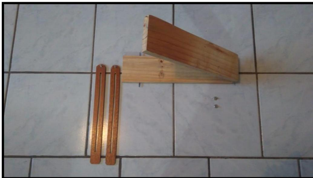
2° Passo: colocar as 02 chapas de madeira de largura 3,2 cm, comprimento 35,6 cm e espessura 0,5 cm com fenda de 0,5 cm no centro nas duas laterais das duas chapas de madeira utilizando parafusos.
