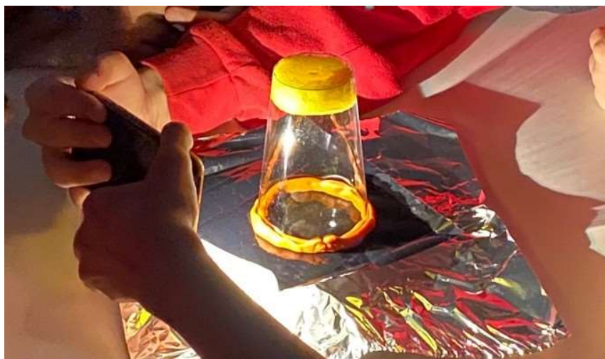
Figura 16 – Montagem experimental da câmara de nuvens
