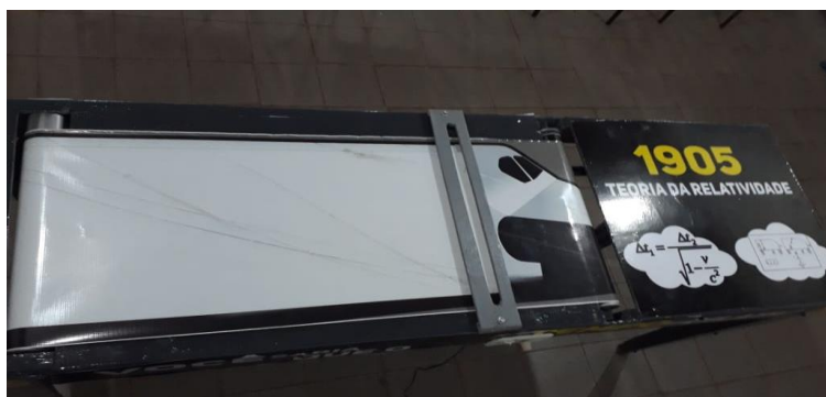
Figura 15: Vista de cima do dispositivo, mostrando a parte que deve ser rabiscada na tela e que deve mostrar a trajetória do pulso luminoso na experiência. Fonte: Autor, 2018.
