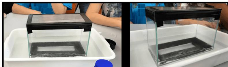
Enquanto espera para o término do procedimento anterior prepare o dispositivo para receber o gelo seco, cubra com apenas uma parte do feltro preto, conforme a figura (71).
