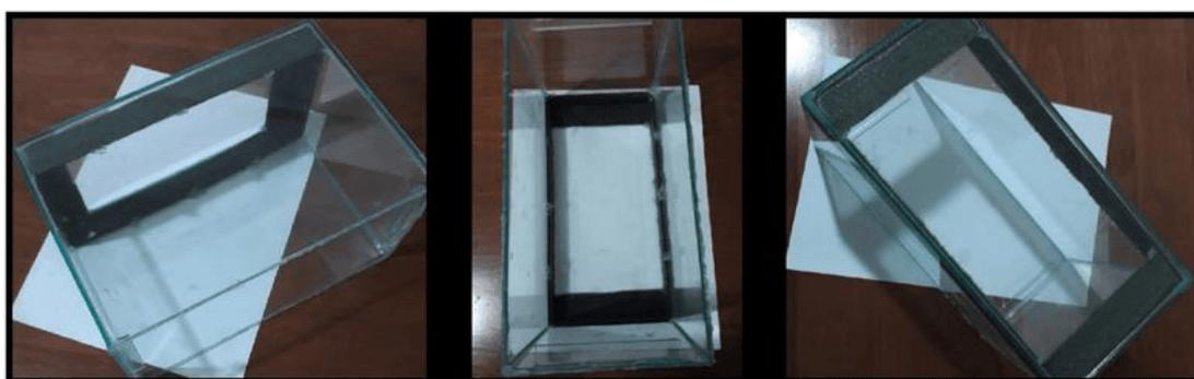
Pronto! Montagem realizada! Se julgar adequado, para intensificar a nuvem cole mais uma tira de *veda-frestas* exatamente no fundo do aquário que será a parte superior do funcionamento.
