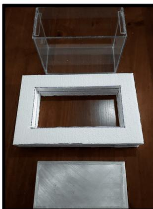
A colagem das peças deve ser feita com cola branca e demora em torno de três horas. O esquema de montagem está indica na figura (64).
