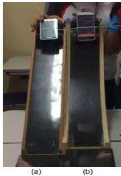
Figura 42 - Pistas para experimento (a) rampa ou plano inclinado e (b) cicloide invertida ou curva cicloide
