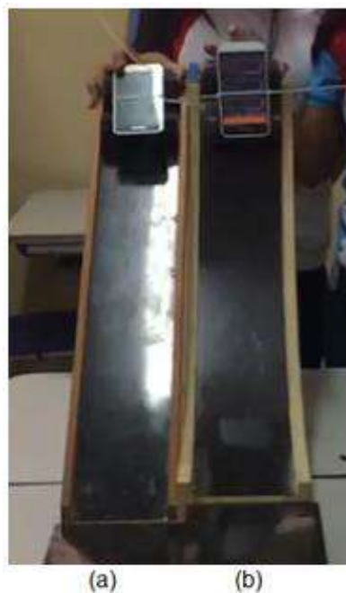
Figura 17 - Pistas para experimento (a) rampa ou plano inclinado e (b) cicloide invertida ou curva cicloide
