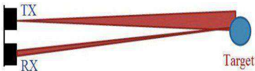
Figura 9. Sensor ultrassônico attingindo alvo. Fonte: eletronicaparatodos.com/
