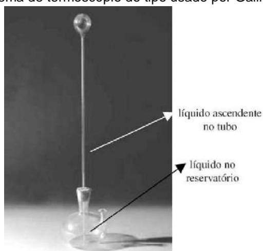
Figura 17: Esquema de termoscópio do tipo usado por Galileu Galilei.
