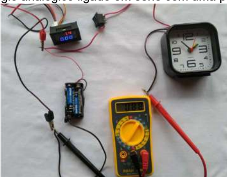
Fig. E.6: relógio analógico ligado em série com uma pilha AA (1,5V)
