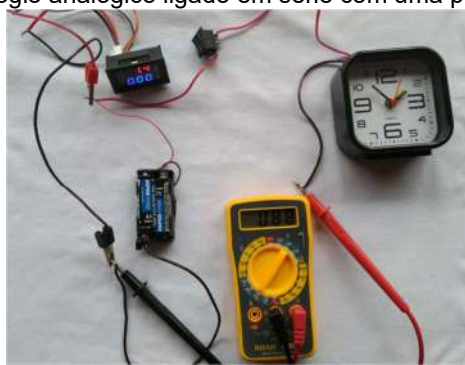
Fig. D.6: relógio analógico ligado em série com uma pilha AA (1,5V)
