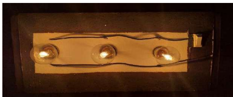
Figura 19 - Circuito paralelo com lâmpadas incandescentes desenvolvido pelos educandos
