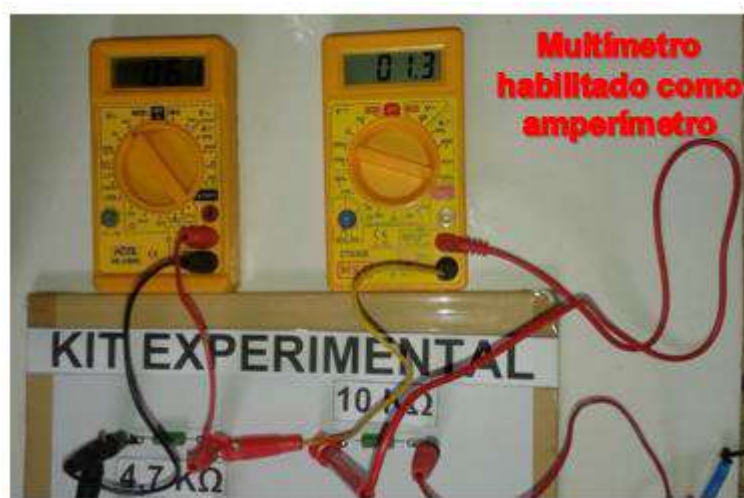
Figura 27 - Corrente no Circuito Divisor de Tensão montado no kit experimental
