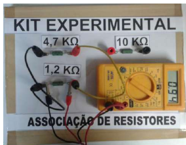
Figura 3. 16 - Foto do kit experimental da medida da resistência equivalente da associação em paralelo de resistores
