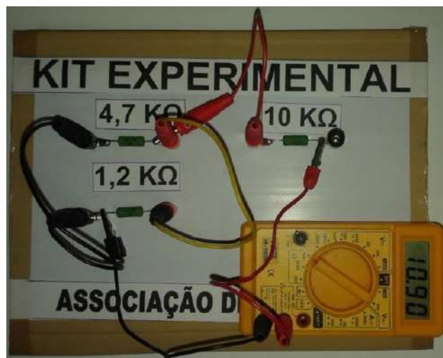
Figura 23 - Resistência equivalente da associação de resistores mista montado no kit disponibilizado pelo professor pesquisador
