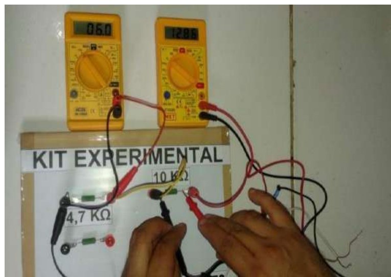
Figura 26- Circuito Divisor de Tensão montado no kit experimental
