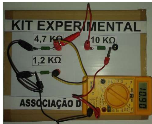
Figura 3. 18 - Foto do kit experimental da medida da resistência equivalente da associação mista de resistores
