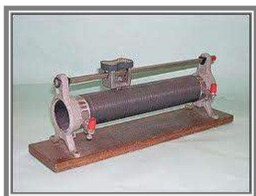
Figura 3. 24 - Reostato de variação contínua
