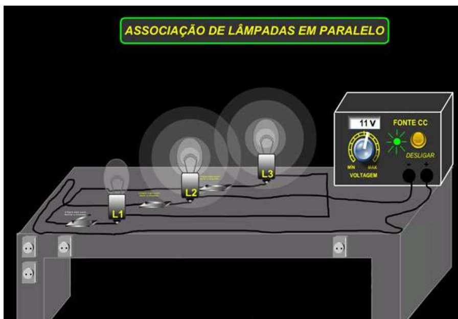
Figura 10 - Montagem Experimental Associação de Lâmpadas.
