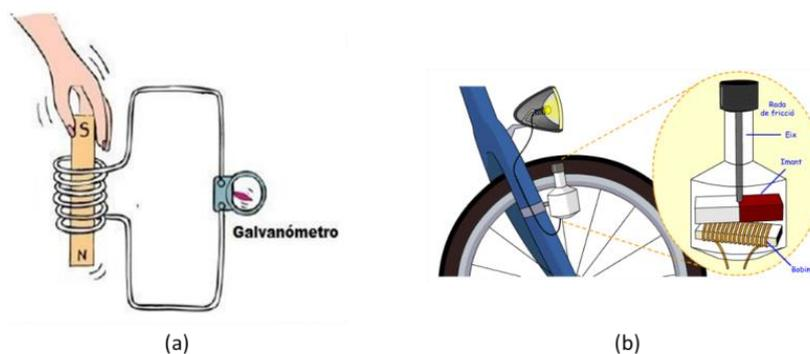
**Figura 3.11:** (a) Esquema que ilustra o experimento realizado por Faraday. Ao aproximar (ou afastar) o ímã de uma bobina, uma corrente elétrica é induzida. (b) Aplicação da indução eletromagnética no dínamo de bicicleta para acender uma luz de sinalização.
