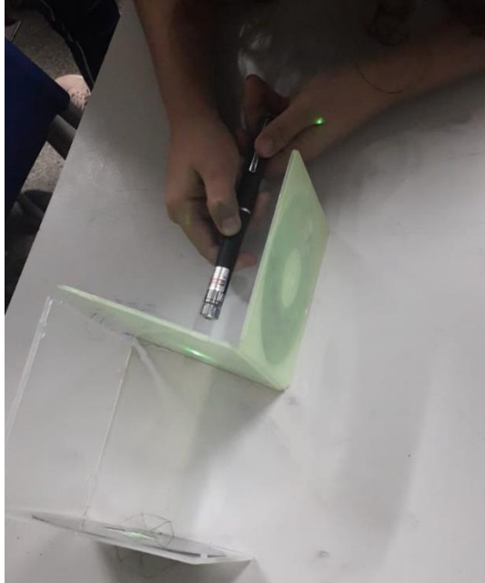
Figura 27 - Montagem para verificação da difração em um fio de cabelo: turma 305
