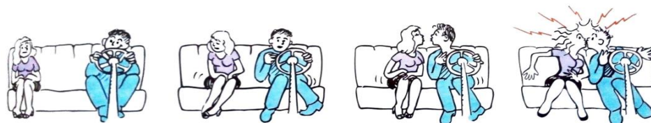
Figura 1: Eletrização por atrito e depois por contato. Fonte: Hewitt 2015, p. 413
