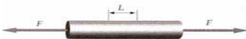
Figura 4.15 Uma barra maciça sujeita a força de alongação de magnitude F que atuam em cada extremidade. Forte: (TIPLER, 2009).
