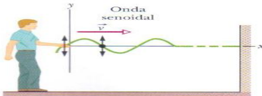
Figura 4.2 Uma onda senoidal é produzida na corda. Um elemento típico da corda se move para cima e para baixo com a passagem da onda. Esta também é uma onda transversal. Fonte: Livro do (HALLIDAY-RESNICK, 2009).
