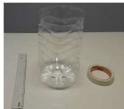
Figura 4.1: Montagem do pluviômetro
