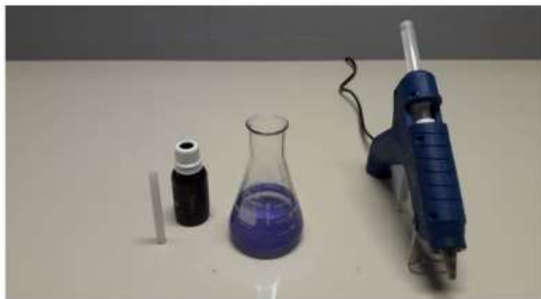
Figura 2:1. Montagem do Termômetro
